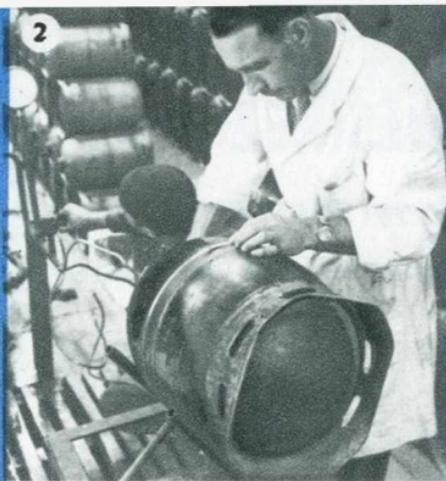
**2** Après ce contrôle, une bouteille sur 200 est soumise à des pressions allant jusqu'à  $70 \text{ kg/cm}^2$
