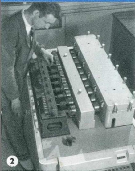
❶ L'étanchéité des rampes et des brûleurs est contrôlée rigoureusement en cours de fabrication et après montage. Voici un contrôle d'étanchéité effectué après assemblage.
