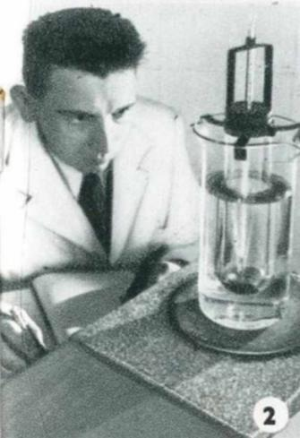
**2** Le gaz ne doit pas contenir de produits qui, dans des conditions normales d'utilisation, ne s'évaporeraient pas. Ce chimiste procède à un essai d'évaporation du gaz. L'évaporation doit être totale. Ce contrôle vous prouve que vous pouvez utiliser la totalité du gaz contenu dans la bouteille.
