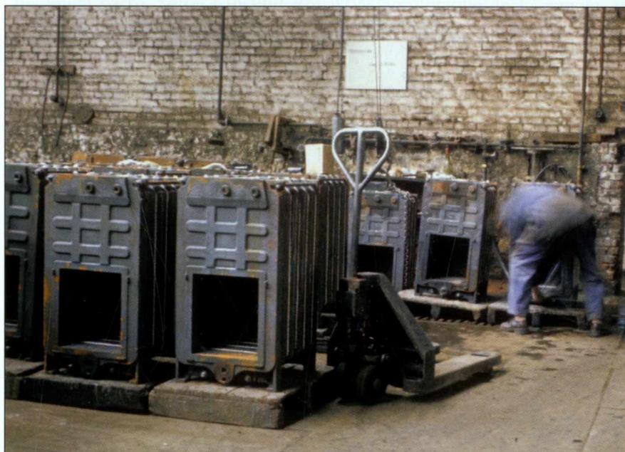
L'assemblage des chaudières et mise sous pression.
