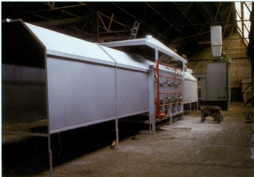
En 1977, on installait un nouveau circuit de peinture pour l'émaillage des tôles des chaudières.
