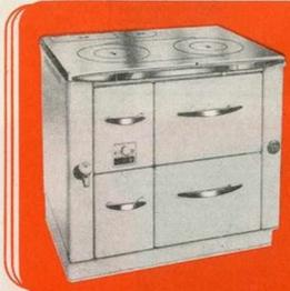
N° 5065 - Avec foyer mixte, à bois et charbon, avec et sans chaudière (avec foyer pot à houille sur demande). Acier sur châssis fonte. Émaillé blanc. Dessus meulé. Barre, poignées et robinet chromés. Portes abattantes.
