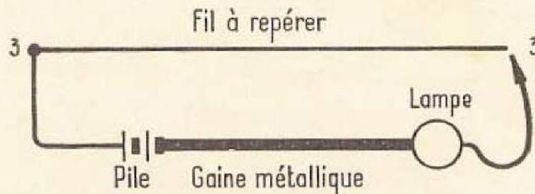
FIG. 46. — Repérage d'un câble court à gaine métallique
