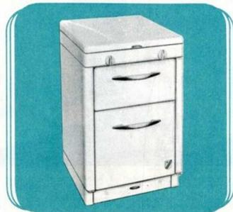
Avec couvercle, émaillé blanc, entièrement calorifugé - Poignées chromées - Dessus menué, rondelle et tampon à récupération de chaleur - Buse dessus ou derrière (à préciser à la commande). Four chauffé symétriquement avec plafond émettant des rayons infra-rouges. Consommation : 5 kgs environ par 24 heures - 80 gr. heure au ralenti.
