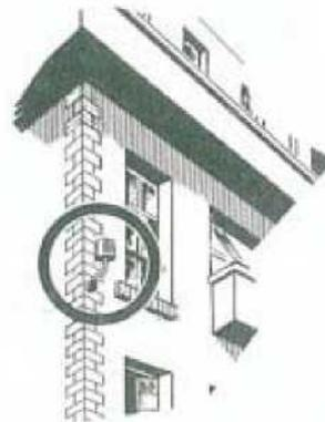
Le déperditeur, appareil simple, d'une pose facile et d'un prix modique, est à lui seul un petit immeuble témoin équivalent thermiquement au bâtiment à contrôler.
