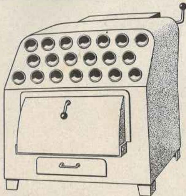
Ce système permet, par un chauffage direct des tubes disposés de façon à établir un mouvement d'air continu, de dégager **immédiatement la chaleur dans la pièce** avec une **consommation de combustible très réduite.**
