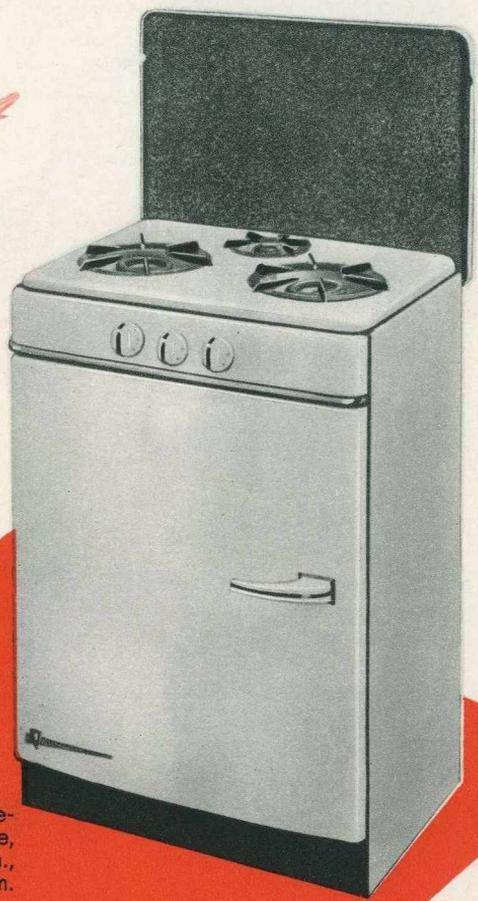
Réchaud-buffet bâti acier dossier enveloppant, taque relevable, grilles fonte, cuvette de propreté. Largeur 560 mm., profondeur 400 mm., hauteur 800 mm.
