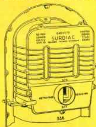
Fig. III. — Récupérateur breveté SURDIAC adapté à un modèle de fabrication actuelle.
