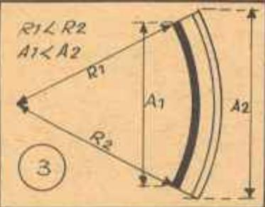
Fixons ces lames entre elles aux deux extrémités par rivets ou soudure, etc., nous obtenons ainsi un bimétal ou bilame dont le fonctionnement saute aux yeux immédiatement. Reprenons en effet notre exemple (fig. 2) en fixant toutefois les lames comme indiqué ci-dessus.
