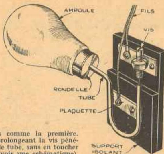
deux trous comme la première. L'aiguille prolongeant la vis pénétrera dans le tube, sans en toucher les parois (voir vue schématique). Le tube sera presque rempli de mercure, ce que l'on fera en retirant la vis à l'aiguille pour laisser le passage libre.
