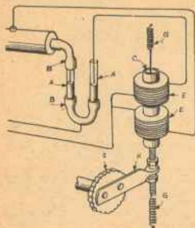
Ils s'équilibrent l'un à l'autre pour qu'à la position de repos le barreau D soit exactement situé entre les bobines E1 et E2.
