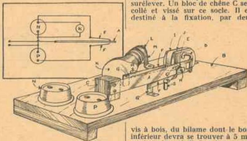
l'une de leurs faces seront ensuite étamées soigneusement sur toute leur surface à l'aide d'un fer bien chaud. Pour les assembler définitivement, on procédera comme suit : dans du fer plat de 30 mm de largeur, assez épais, 8 mm par exemple, découpez deux barres un peu plus longues que les lames de fer et de zinc. Ces deux barres
