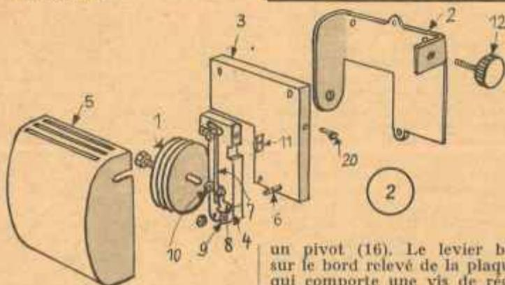
La tige soudée sur la boîte viendra s'appuyer sur le rebord d'une plaquette (8) axée sur un pivot (17). (Voir fig. 1.) Cette plaquette, de 1 à 2 mm d'épaisseur, sera maintenue en butée sur la tige de la boîte par un ressort à boudin faible (9). La plaquette (8) supportera un levier (7) axé sur
