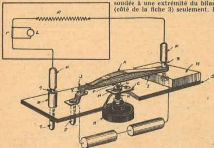
ce point les trois lames sont percées d'un trou de 3 mm pour le passage de la fiche 3, qui les maintiendra sur la cale H, par serrage de l'écrou.
