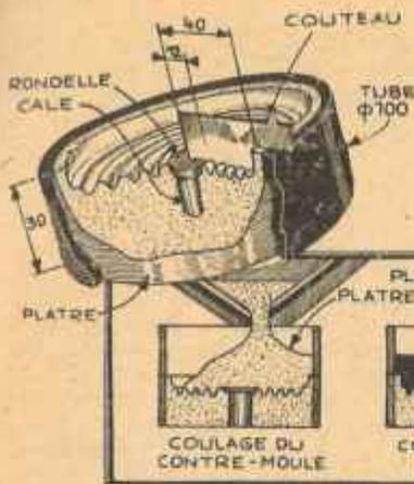
pour obtenir le contre-moule. Laissez durcir pendant vingt-quatre heures et démontez. Il est inutile de retirer le cylindre ULTIMHEAT®. Il faudra alors au VIRTUAL MUSEUM de laisser sécher une dizaine de jours les deux plâtres obtenus pour qu'ils soient parfaitement
