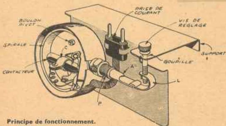
**Principe de fonctionnement.**
