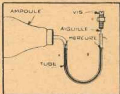
Prenez ensuite une longueur de 8 à 10 cm de tube de cuivre de 3 mm de diamètre environ (le trou percé dans la rondelle aura le même diamètre), recourbez-le en U, avec une branche prolongée comme le montre le dessin ci-contre, puis soudez-le, par cette dernière, à la rondelle du culot.
