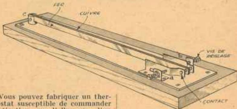
Vous pouvez fabriquer un thermostat susceptible de commander l'extinction ou l'allumage d'un circuit électrique suivant les variations de température, avec des pièces de rebut que tout bricoleur trouvera facilement dans ses réserves.
