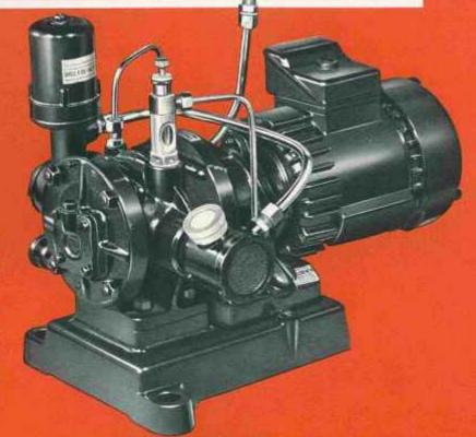
CE GROUPE ÉLECTRO-SURPRESSEUR COMPRE-NANT : UN MOTEUR D'UNE VITESSE DE ROTATION DE 1000 T/M 0,5 CV UN SYSTÈME COMPLET DE LUBRIFICATION SOUS PRESSION. UN RÉGULATEUR DE PRESSION ET UNE SOU-PAPE ANTIPULSATIVE, PERMET D'ALIMENTER UN MAXIMUM DE CINQ BRULEURS EN FUEL ET EN AIR DE PULVÉRISATION.
