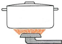
Pour réduire progressivement la puissance du brûleur, continuez à tourner vers la gauche jusqu'à la butée qui donne la position minimum ou veilleuse.
