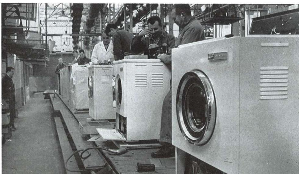
Bagnolet. Pose des carrosseries et emballage. Un contrôleur vérifie l'état du revêtement et dirige sur les postes de retouche les machines dont l'aspect n'est pas absolument parfait (la face avant de la machine située au premier plan devra par exemple être retouchée).
