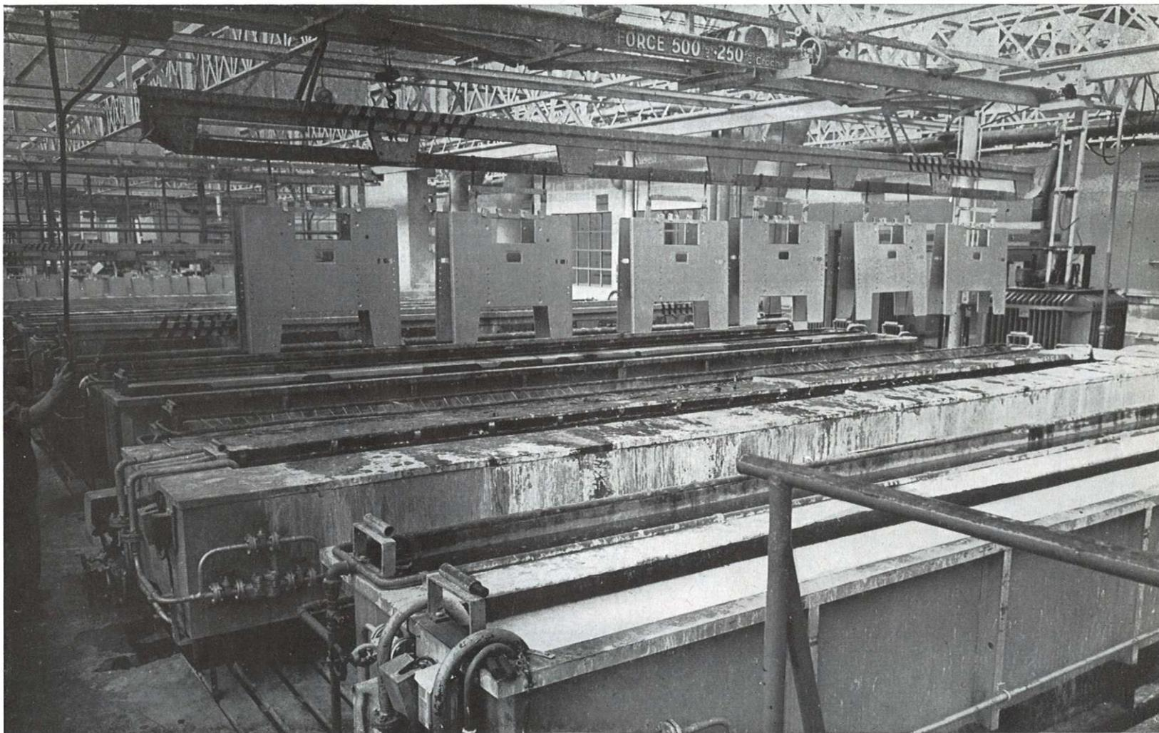
Atelier de traitement des cuves. Un important secteur de l'usine de Fourmies est consacré au traitement des cuves « alufroid ». Les emboutis en alliage léger subissent dans 17 baignoires successives un traitement complexe (dégraissage, blanchiment, anodisation, colmatage, etc.) leur assurant une stabilité chimique absolue.
