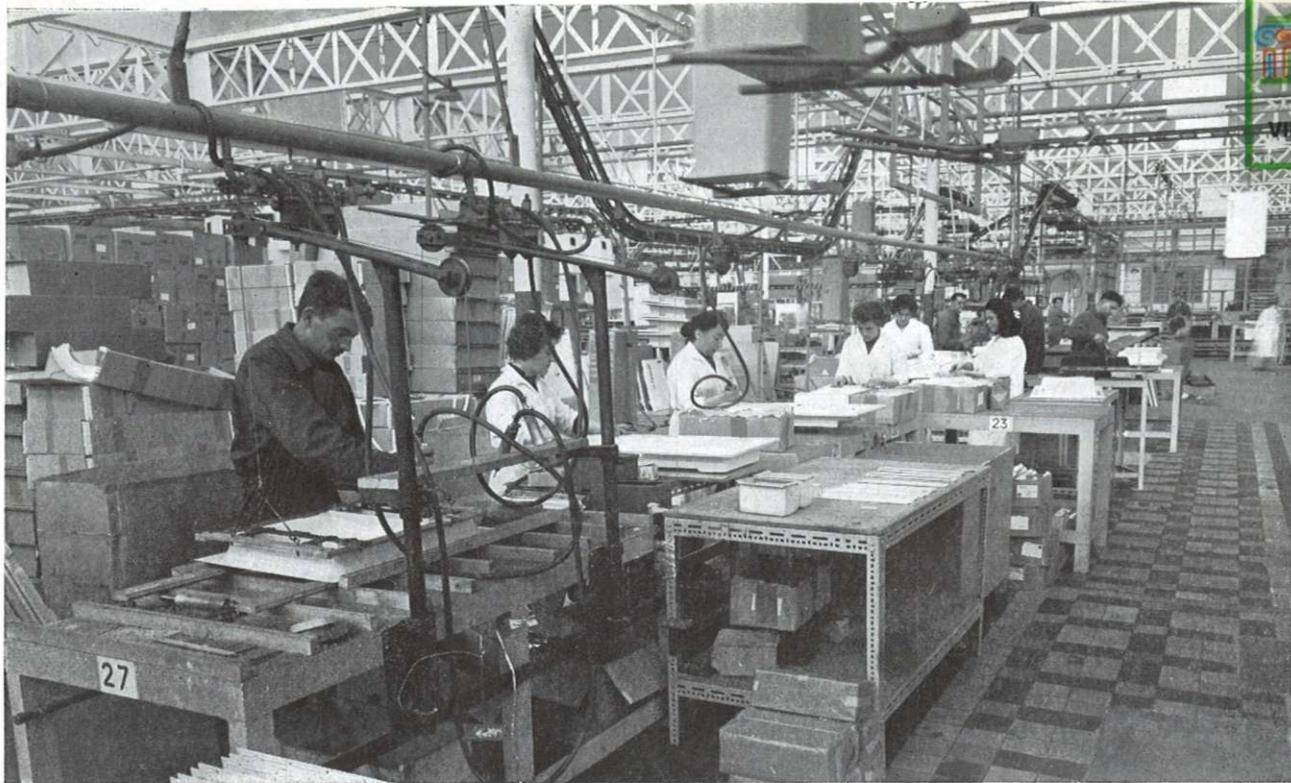
Equipement des portes. Les perçages s'effectuent à travers un gabarit suspendu à une potence à contre-poids (poste de gauche). Sur chacun des postes de cette chaîne qui utilisent des outils pneumatiques (perceuses ou visseuses), l'ouvrier dispose d'un outil de rechange prêt à fonctionner.
