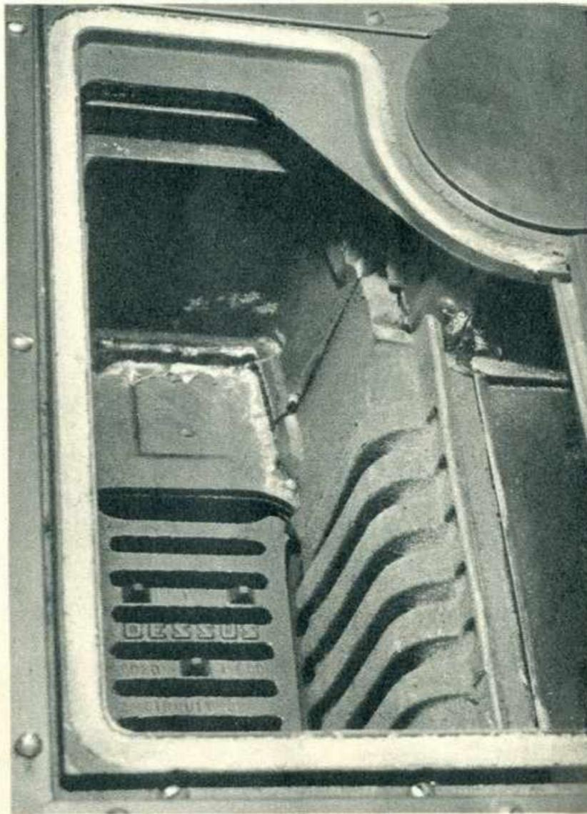
rectangle dont l'une des parois est formée par la parabole du foyer. Les autres parois sont en tôles épaisses ou en fonte, selon les constructeurs. Flamme et gaz de combustion sortant du foyer passent entre la taque et le dessus du four puis descendent sur le côté (entre le four et la paroi extérieure) puis sous le four, entre celui-ci et l'étuve. Ils remontent ensuite derrière le four.
