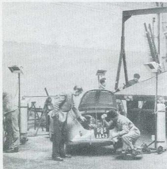
Suivant les besoins, le poste infra-rouge mobile peut être équipé d'un ou de deux radiants ANTARGAZ (Welda).
