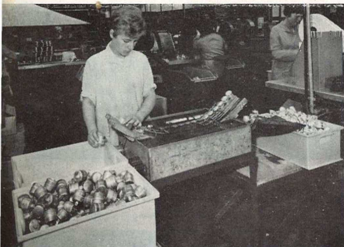
Poste de vérification d'étanchéité des flotteurs
