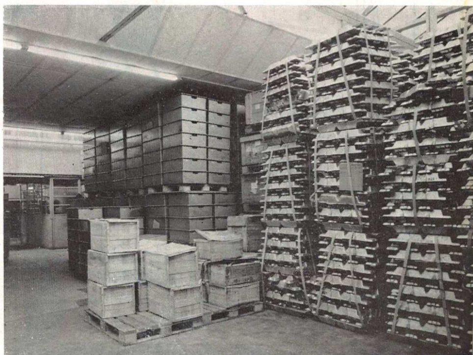
Stockage intermédiaire des pièces en provenance de l'extérieur et qui feront l'objet d'un contrôle par prélèvement statistique. ▼
