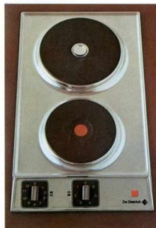
ELEMENT ELECTRIQUE 403 Table de cuisson en inox satiné - Ultra-plat: possibilité d'installer un tiroir dans le meuble sous la plaque - 2 plaques électriques ultra-rapides 9146 mm - 1500 W, 9180 mm - 2000 W à commande thermostatique - Bandeau de commande en alu brossé sous verre - Voyant lumineux de mise sous tension - Dimensions de l'élément: L x P: 28,8 x 51 cm - Découpe d'encastrement: L x P: 26,5 x 48,6 cm - Puissance totale: 3,5 kW - Tension: 220 V
