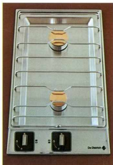
ELEMENT GAZ 402 Table de cuisson en inox satiné - 2 brûleurs à flamme pilote: 1 sans-pilote, 1 rapide - Allumage électronique commandé automatiquement par l'ouverture du robinet - Grille inox - Bandeau de commande en alu brossé sous verre - Dimensions de l'élément: L x P: 28,8 x 51 cm - Découpe d'encastrement: L x P: 26,5 x 48,6 cm
