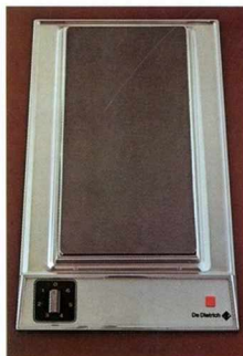
ELEMENT ELECTRIQUE 404 Table de cuisson en inox satiné - Ultra-plat: possibilité d'installer un tiroir dans le meuble sous la plaque - Plaque électrique rectangulaire, commandée par commutateur à 3 positions - Bandeau de commande en alu brossé sous verre - Voyant de mise sous tension - Dimensions de l'élément: L x P: 28,8 x 51 cm - Découpe d'encastrement: L x P: 26,5 x 48,6 cm - Puissance totale: 2,5 kW - Tension: 220 V
