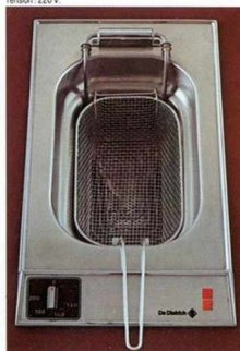
ELEMENT FRITEUSE 405 Table et bac d'une seule pièce en inox 18/8 - Fond de bac en forme d'entonnoir avec robinet de vidange - Capacité du bac: 4 litres - Résistance de chauffe amovible - Laine avec couvercle en inox, panier à frites et accessoires pour l'accrochage du panier - Bandeau de commande en alu brossé sous verre - Manette thermostatique de 120 à 200°C - Voyant rouge de mise sous tension - Voyant orange de fonctionnement de la résistance de chauffe - Dimensions de l'élément: L x P: 28,8 x 51 cm - Découpe d'encastrement: L x P: 26,5 x 48,6 cm - Puissance totale: 2,5 kW - Tension: 220 V
