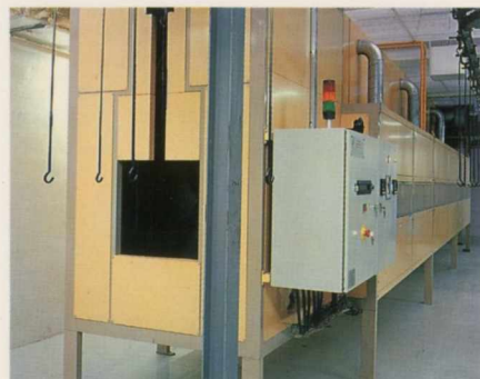
L'UNITE HERMETIQUE: Polymérisation de poudres sur compresseurs.
