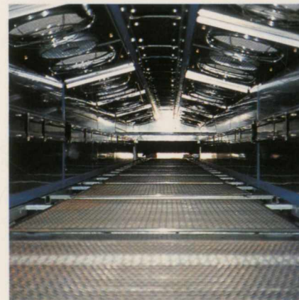
Tunnel à plat. Pièces fines en aluminium pour pièces aéronautiques. Régulation fractionnée en 3 zones.
