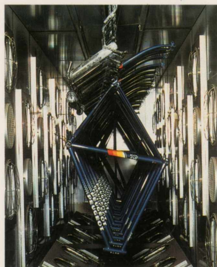
PEUGEOT CYCLES : Plusieurs tunnels de polymérisation pour apprêts, base + vernis.
