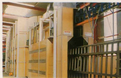
TRAILOR: Ensemble cabine de peinture + tunnel de sèchage équipé de 72 thermoréacteurs.
