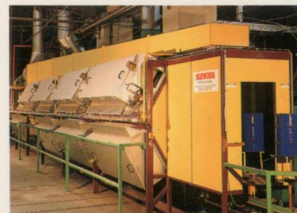
Polymérisation de laque glycéro sur fûts métalliques. Durée : 4 mn.
