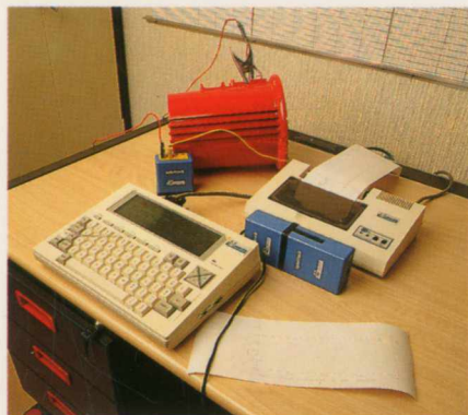
Appareil de mesures et d'enregistrement des courbes de températures du film de peinture pendant la polymérisation.
