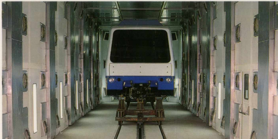
GEC ALSTHOM : Double cabine et tunnel de polymérisation. Régulation optimisée : gestion indépendante de la température du feu de peinture de celle de l'air ambiant. Masquabilité après 55 mn seulement.
