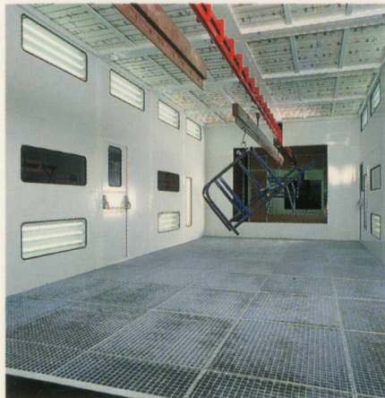
2 cabines intégrées à une chaîne. Application mouillé sur mouillé. Apprêt + peinture.
