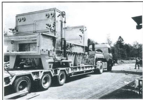
Sas de four, entrée et sortie, destiné à une usine de traitement du cuivre (recuit de boules de cuivre de 300 mm de diamètre). Mécano-soudure utilisant en partie de l'acier réfractaire. Le transport de l'ensemble avait nécessité un convoi exceptionnel.
