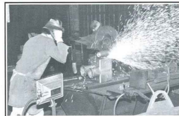
Coupe : séparation de la pièce des artifices de coulée.
