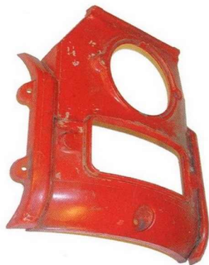
Modèle en bois, d'une face avant d'un poêle Nestor Martin, utilisé pour la fabrication du moule dans lequel est coulée la fonte en fusion (La Fonderie, fonds Nestor Martin, inv. 1).
