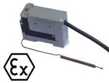
以与破损安全沸腾切断相同的机械基底为基础，并且可在同样的温度范围完成，这些温控器使用一个防爆开关。这个方法的优点是避免沉重和昂贵的 IIB 或 IIC 防爆外壳。温控器输出电缆的连接必须在一个“提高安全”的外壳或危险区域的外面进行。最新版本包括一个内置的提高安全性的“e”外壳。根据不同的型号，电气额定值可以从 16A 250V 单刀双掷到 15A 400V 单刀双掷。两极的版本同样也可以。
