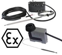
建立在与标准温控器相同的机械操作的基础上，达到同样的温度范围，这些温控器使用一个具有独特设计概念的防爆微动开关。这个系统的优点是避免沉重及昂贵的 IIB 或 IIC 金属盒，并且无需关闭电源便可进行温度设定调节。温控器可以安装在 Y 8 系列标准的防水外壳里，但它的输出电缆连接必须要在一个“增加安全”的外壳或危险区域外进行。现时最新的版本包括一个内置的增加安全型的外壳。根据不同的型号，电气额定值可以从 5A 250V 单刀双掷到 15A 400V 单刀双掷。也可以提供两极的版本。
