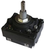
该能量调节器是一种具有加热电阻器与微型弹片接触的双金属温控器。此内部电阻的功率加热弹片，其中会变形，并切断电阻的供应。然后弹片冷却，触点闭合，开始了一个新的周期，就像闪光一样。设定销可以改变打开和闭合之间的时间比率，并让电气连接到一个外部负载，与内部电阻并联。这个简单的系统，可让您连续不断地调节，以令加热器运作。电源电路必须要详细地注明，就像微型的内部加热器那样注明是根据这张力而制成的。
