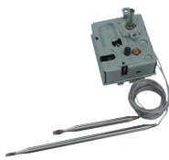
这些设备在跟控制温控器相同的原理上运作，但其特别是配备了双球管，一个用于控制，另一个用于手动复位。它们有一个调整轴作控制，并且当温度上升后它打开，手动复位按钮允许再次打开安全电气触点。安全设定值是出厂时固定的。仅在温度上升时触点才打开。虽然有单极常开和双极常开的版本，它们主要用于三相的应用里。
