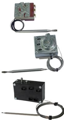
球管和毛细管温控感应装置，通常命名为“膜盒式温度感应装置”是由一个闭合的空间、一个球管、一个毛细管和由两薄膜组成的收缩盒所制成，在真空下用液体填充。当球棒周围温度上升时，液体的体积膨胀，致使膜也膨胀。这个位移是用来激活快动开关机械装置。一个螺纹轴，用于修改收缩盒的位置以进行温度调节。在标准的设备（非故障安全），膜盒式温度感应装置发生渗漏时，当温度上升收缩盒缩紧，并且触点保持闭合。最常见的范围从  $-35$  到  $+320^{\circ}\text{C}$ 。高设定点可达  $750^{\circ}\text{C}$ ，但它们要求毛细管液体能够承受这样的高温而不沸腾。这些高温版本（范围在  $400^{\circ}\text{C}$  以上）使用液态金属作为填充液体，通常是钠钾共晶。一旦膜盒式温度感应装置破裂或泄漏，该液体与水或空气中的湿气接触时是可燃的。因此，在他们的应用中有必要考虑到这一点。
