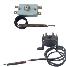
这些装置的操作与液体膨胀温控器的原理不相同。它们使用 50 年前由 Wilcolator 公司发明的一种简单的机械装置。由于液体在一个密封的空间里沸腾，通过增加巨大的压力来激活凸起的碟形元件的快速动作。这种设计理念提供了非常简单的机械装置。技术在于选择不同沸点的液体。操作温度范围与使用的液体及其沸腾温度有关。由于在沸腾过程中引致压力减损，阻碍它操作，因此毛细管的长度也是有限制的。
