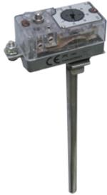
这些温控器的温度控制是采用最古老的系统，首个是在 1783 年由法国工程师 Jean Simon Bonnemain 发明的。它们使用两种金属的差值膨胀来激活一个机械系统。它们被广泛地应用于储水式热水器和锅炉。它们的校准是不像液体膨胀球管及毛细管温控器那样受环境温度变化而偏移。它们可以是控制动作或手动复位动作。它们的特性是测量棒，以确保调节头和电触点的安全。
