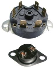
用作控制温控器或带手动复位的安全温控器，这些温控器由两种不同的金属层压在一起以用于感温元件。这两种金属有不同的膨胀系数。因此，一个凸圆的碟片，将随温度的升高而逐渐改变形状，直到它突然从凹状变成凸状。当温度下降，它以快速的动作恢复到其原来的形状。这突如其来的变化激活一块触点弹片。这些温控器有一极、二极或三极触点。达到准确的温度和低差值的技术是复杂的，少数厂家提供准确值和低差值。
