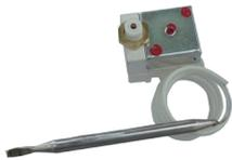
这些装置的操作原理与液体膨胀球管及毛细管温控器相似，都是不可调的。它们包括有一个复位按钮，当温度上升电气触点打开时，用此复位按钮来闭合电触点。
