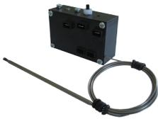
这些装置的操作与控制温控器的原理相同，但是特征是当温度上升后它打开时，用一个复位按钮来关闭电气触点。在一个机械温控器或一个电子控制器后面，它们可以被用作过热安全系统，该类型的温控器带有与控制温控器同样的调节范围并带有一个转换触点（这无需传输能发出一个缺陷信号），并且范围高达 750°C。
