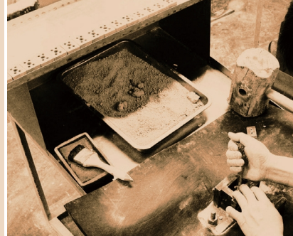
Borniers en porcelaine fabriqués manuellement par pressage au marteau : remplissage manuel du granulat humecté (Collection privée)
