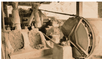
Machines de production traditionnelle des poudres (水碓 shui dui), utilisées pour fabriquer de la porcelaine électrique (collection privée)
