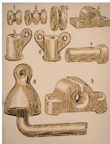
1885 Isolateurs électriques en porcelaine (La physique moderne : l'électricité dans la maison, E. Hospitalier)
