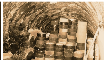
Four Dragon traditionnel chinois (龙窑 Long Yao), vue de la bouche d'alimentation et méthode de remplissage avec des porcelaines électriques (collection privée).
