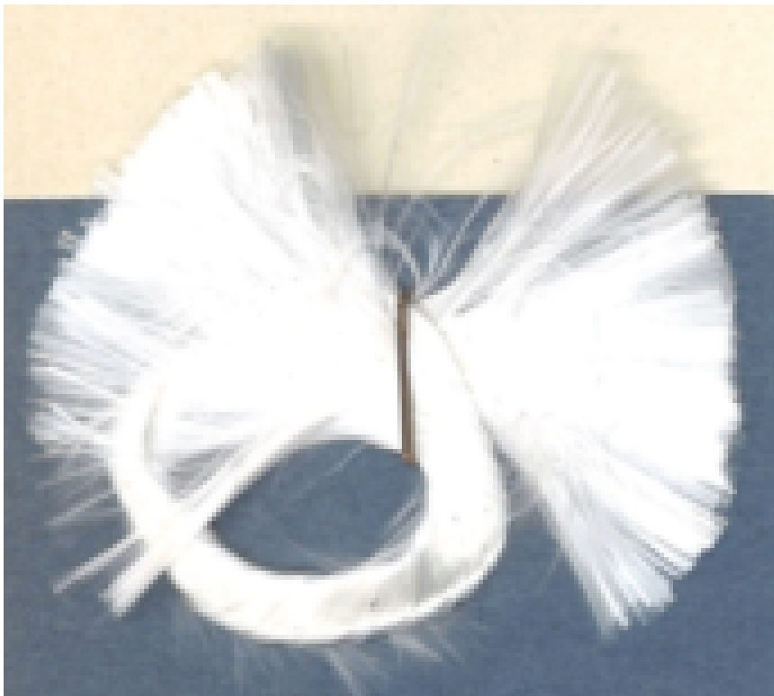
形成单根电线的玻璃丝束 (玻璃丝的生产，大约在 1960 年，来自比利时的韦尔维耶的纺织学校的课程，Ultimheat 博物馆)
