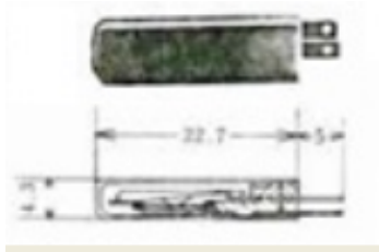
1978年 Uchiya 研发了微型限制器 8X5, (22.7x4.4x 6.8mm) 带快速闭合功能，用于毛毯加热器。它的防水版本变成了 UP32 型号 (Ultimheat 博物馆目录书)。
