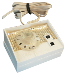
约 1970 年，在英国发热毛毯上的 GEC 功率设定（通用电气，英国）。预期的电阻在双金属和慢的断路器的上方清晰可见。（Ultimheat 收集）
