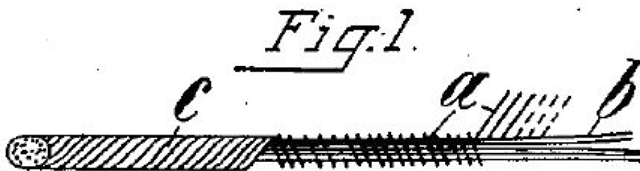
发热线（于1901年由 Camille Herrgott 发明）。A = 发热丝；B = 纺织芯；C = 在发热丝外部以相反方向缠绕。
