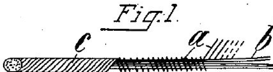
Corde chauffante (brevet Camille Herrgott, 1901). A= fil chauffant ; B= âme textile ; C= guipage extérieur bobiné en sens inverse du fil chauffant
