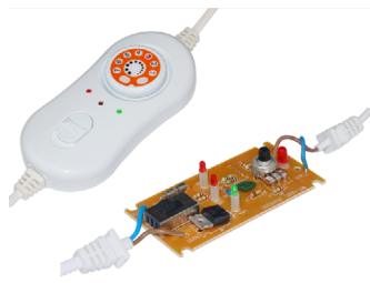
2019 Boitier de commande de couvertures chauffantes à réglage de puissance électronique continu (Collection Ultimheat)
