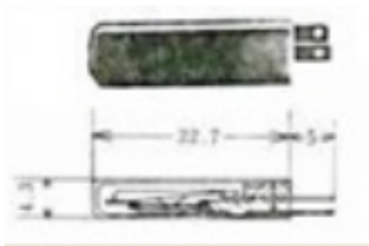
1978 Uchiya développe le limiteur miniature 8X5, (22.7x4.4x 6.8mm) à rupture brusque, pour couvertures chauffantes. Dans une version étanche, il deviendra le modèle UP32 (Catalogue Musée Ultimheat)
