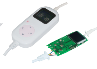
2019 Boitier de commande de couvertures chauffantes à réglage de température à affichage digital par une sonde à thermistance incorporée dans la zone chauffante (Collection Ultimheat)
