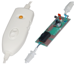
2019 Boitier de commande de couvertures chauffantes à réglage de puissance électronique continu (Collection Ultimheat)
