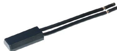
2019 ตัวจำกัดอุณหภูมิแบบสแนปปิดสำหรับหม้อแปลงทำความร้อนซึ่งได้มาจากรุ่น 1966 ของ Texas Instruments 7AM ใช้งานได้ทั้ง 230 โวลต์ ในปลอกพลาสติกกันน้ำ ช่วงอุณหภูมิ 5 ถึง 8°C ประเภท V7AM (คอลเล็กชัน Ultimheat)
