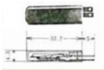
1978 Uchiya พัฒนาตัวจำกัดขนาดเล็ก 8X5, (22.7x4.4x 6.8 มม.) พร้อมตัวสแนปปิดสำหรับตัวทำความร้อนของผ้าห่ม รุ่นกันน้ำของมันกลายเป็นรุ่น UP32 (แคตตาล็อกพิพิธภัณฑ์ Ultimheat)
