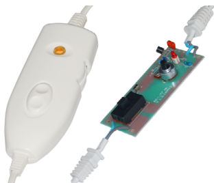
หน่วยควบคุมผ้าห่มที่ควบคุมพลังงานด้วยอิเล็กทรอนิกส์อย่างต่อเนื่อง (2019) (คอลเล็กชัน Ultimheat)
