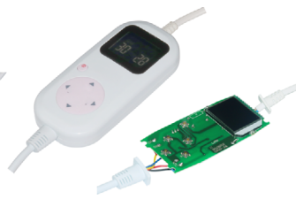
2019 ชุดควบคุมสำหรับผ้าห่มทำความร้อนที่ควบคุมอุณหภูมิพร้อมจอแสดงผลดิจิตอลผ่านหัววัดอุณหภูมิเทอร์มิสเตอร์ที่รวมอยู่ในพื้นที่ทำความร้อน (คอลเล็กชัน Ultimheat)
