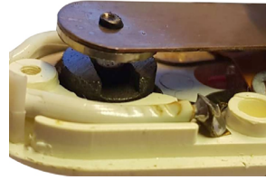
1972 กล้องควบคุมพลังงานทำโดย Jidé ใน Limoges ภายใต้แบรนด์ Jidéstat ประสบความสำเร็จสูงสุดจากทุกระบบ ขนาดที่เล็กมาก สามารถปรับได้และรวมอยู่ในปลั๊กไฟฟ้า นี่เป็นรุ่นเดียวที่มีหน้าสัมผัสแม่เหล็กแบบสแนป มันไม่ได้ถูกแทนที่โดยระบบเครื่องกลไฟฟ้าจนกระทั่งยุคปัจจุบัน (คอลเล็กชัน Ultimheat)
