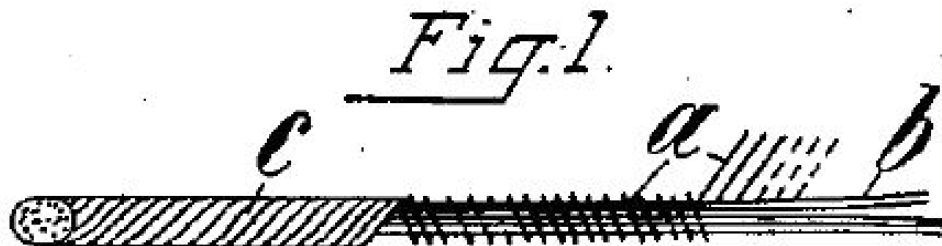
สายไฟทำความร้อน(จดสิทธิบัตรโดย Camille Herrgott ปี 1901) A = ลวดทำความร้อน B = แกนสิ่งทอ C = ส่วนห่อหุ้มภายนอกพันในทิศทางตรงกันข้ามของลวดทำความร้อน
