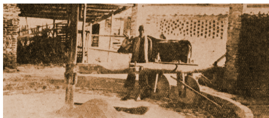
用一头牛拖动研磨机来研磨高岭土 （1939 年，Vienam，印度支那半岛经济期刊）
