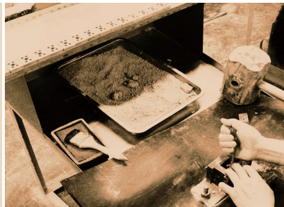
高频瓷端子接线柱手工锤子压制：手动 填充湿的颗粒 (私人收藏)。压制后电 高频瓷的干化 (私人收藏)
