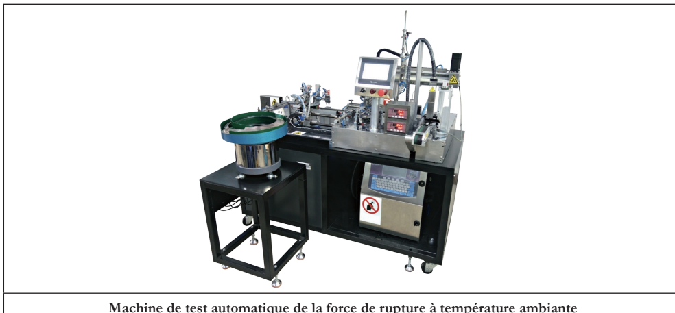
Machine de test automatique de la force de rupture à température ambiante
