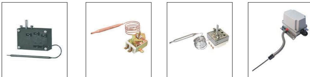
C'est la famille la plus courante pour la mesure et la régulation de température à distance. Les longueurs de capillaire peuvent aller jusqu'à 3 mètres, mais avec une dérive notable due à la quantité de liquide comprise dans le capillaire.
