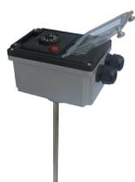
Ce modèle est une variante du thermostat à canne à dilatation bimétallique. Il s'en différencie par une meilleure résistance aux vibrations mais un temps de réponse plus long. Les applications sont identiques. Les plages courantes de température vont de  $-50^{\circ}\text{C}$  à  $400^{\circ}\text{C}$ , exceptionnellement jusqu'à  $760^{\circ}\text{C}$ .
