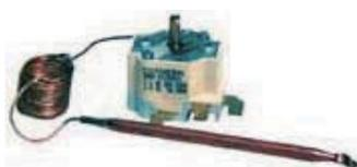
Ces appareils à tension de vapeur sont principalement utilisés dans les thermostats d'ambiance incorporés dans les convecteurs électriques, en raison de leur faible différentielle et de leur faible inertie thermique.
