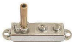
Ces appareils de régulation, réglables, à rupture lente, ont une très grande précision, et une faible différentielle : inférieure à  $1^{\circ}\text{C}$ . Ils se montent à plat sur une paroi, fixés par 2 vis. Cependant en raison de leur rupture lente, génératrice de parasites en 230V, leur utilisation en Europe est marginale, limitée à des utilisations de laboratoire ou lorsque des
