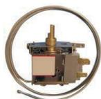
Ces thermostats sont utilisés dans le contrôle de la température de systèmes frigorifiques. La faible inertie thermique du système à capillaire, et la possibilité d'obtenir des différentielles importantes est la principale particularité de ces appareils à tension de vapeur.
