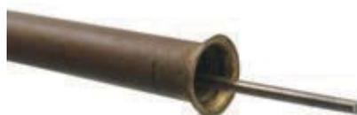
Les cannes sont formées d'une enveloppe externe dilatable, inox ou cuivre ou laiton, et d'une tige interne en Invar. Les dilatations sont du même ordre que les cartouches. Ce principe est à la base de la plupart des thermostats de chauffe eau actuels. C'est un système très simple, très fiable, dont les temps de réaction sont très rapides, puisque c'est l'enveloppe elle-même qui mesure la température.
