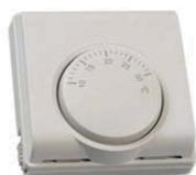
Ce sont actuellement des dérivés des thermostats de couveuse utilisés dans l'élevage depuis des dizaines d'années. La partie sensible est une capsule de type barométrique (capsule de Vidie) à tension de vapeur. Ils sont fortement utilisés dans les thermostats d'ambiance domestiques. Page courante: 4 à 40°C
