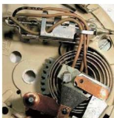
Les spirales bimétalliques ont été largement utilisées pour la réalisation de thermostats d'ambiance. Ce système est maintenant abandonné par les constructeurs européens, car il obligeait à utiliser un contact à ampoule de mercure, ou un contact à rupture lente. Seuls subsistent encore quelques constructeurs aux USA, pour des applications en 110V.
