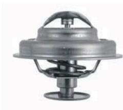
Ils utilisent la fusion de cire. Peu d'utilisation dans des systèmes actionnant un contact électrique, mais souvent utilisés pour obtenir des mouvements mécaniques (thermostat automobiles, thermostats de radiateurs, verrouillage de portes, commande de vannes). Ce système actionne soit un contact électrique, soit une soupape permettant la circulation d'eau lorsque la température monte.
