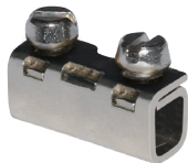
Borne métallique emboutie avec vis avec serrage direct (Utilisée sur les borniers en céramique de fortes sections ou devant résister à des températures très élevées)
