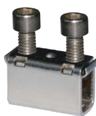
Borne métallique emboutie avec vis avec serrage par plaque de pression. (Utilisée sur les borniers en céramique de fortes sections ou devant résister à des températures très élevées)
