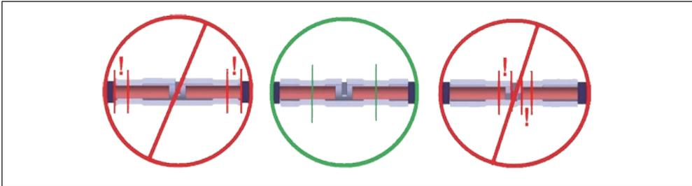
一旦进行了正确的压接，触点电阻值是小于  $5$  毫欧的。压接的结果就是管状连接器的总长度从  $4\%$  增加至  $6\%$ 。
