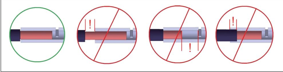
**剥线：**最重要的是使用一个剥线钳，按照指示，不切断电线或损坏绝缘层。达到指定的剥离长度。
