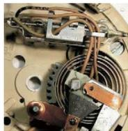
螺旋形的双金属已经广泛地使用在温控器的生产中。这个系统现在被欧洲的制造商放弃了，因为它需要使用一个水银球管触点，或一个慢断开触点。在美国仅有小部分的制造商生产用于 110V 的应用。
