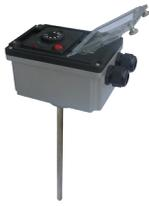
这个系列是双金属膨胀的棒式温控器的变体。它们以较大的抗震动性能来区分，但是有更长的反应时间。应用是完全相同的。目前的温度范围从  $-50^{\circ}\text{C}$  到  $400^{\circ}\text{C}$ ，特殊的情况可达到  $760^{\circ}\text{C}$ 。
