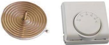
目前它是采自使用在家禽孵化器的孵化温控器，这在 50 多年前已使用。感应的部分是一个大气压力型的膜盒（被称为‘capsule de Vidie’），填充了低沸腾温度的液体。它们广泛使用在家用的室内温控器。目前的范围： $4-40^{\circ}\text{C}$ 。
