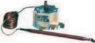
由于它们的低误差和低热惰性。这些蒸汽压力装置主要使用在电子转换对流器温控器。目前的温度范围： $4-40^{\circ}\text{C}$ 。
