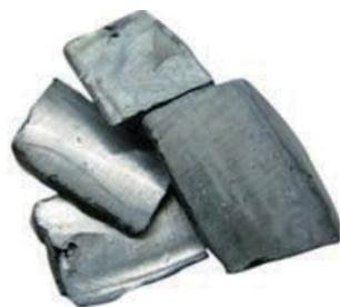
液体类金属是在金属和其他材料之间的分界线。在温控器里，只使用钠和钾，特别是两者的低熔混合物、钠钾合金，其令人最关注的特性是在一个很宽的温度范围里的液体，从周围温度到超过 900°C。它也是一种良好的温度导体。
