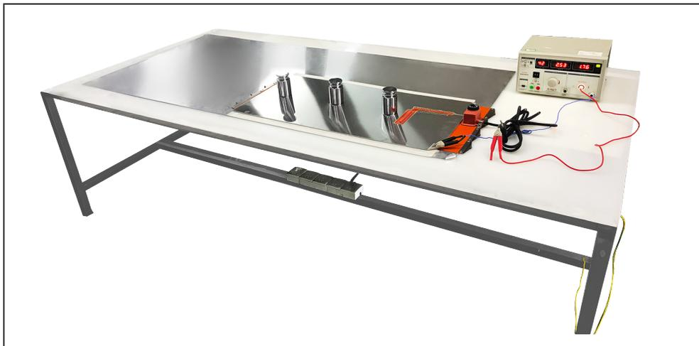
在冷态的条件下总泄漏电流的测量设备
