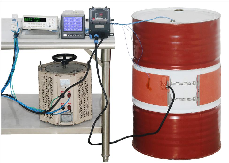
一个 220 升的金属鼓形桶的温度随时间的变化, 填充水, 通过一条 200mm 宽的硅胶加热带进行加热, 不带保暖层, 功率 1500W (表面负载 0.5W/cm<sup>2</sup>)。
