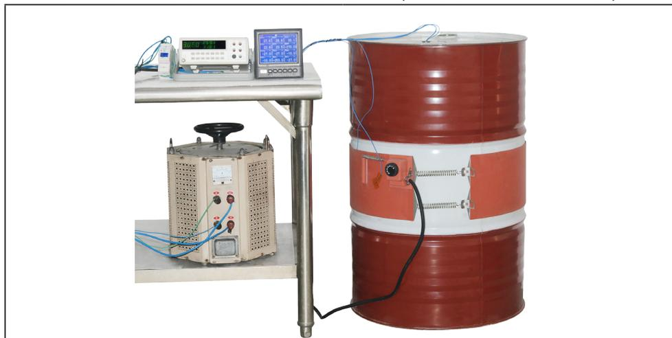
220 升金属鼓形桶的温度随时间的变化, 装满水, 用一块 200mm 宽的硅胶加热带加热, 不带保温层, 功率 2250W(表面负荷 0.75W /cm<sup>2</sup>)。
