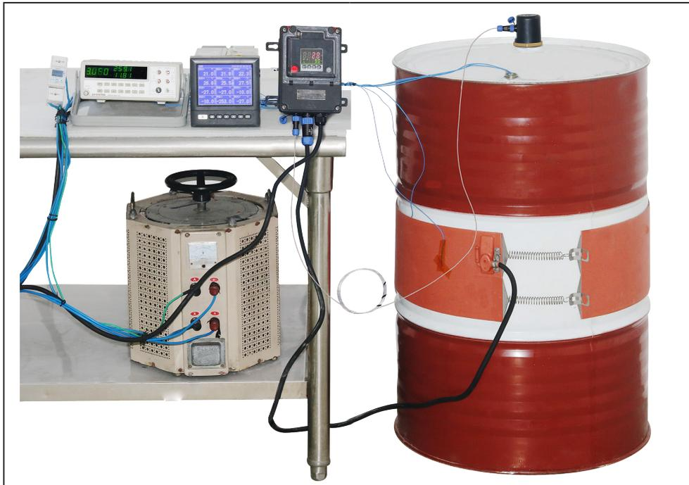
一个 220 升的金属鼓形桶的温度随时间的变化，填充水，通过一条 200mm 宽的硅胶加热带进行加热，不带保温层，功率 2250W (表面负载 0.75W/cm<sup>2</sup>)。
