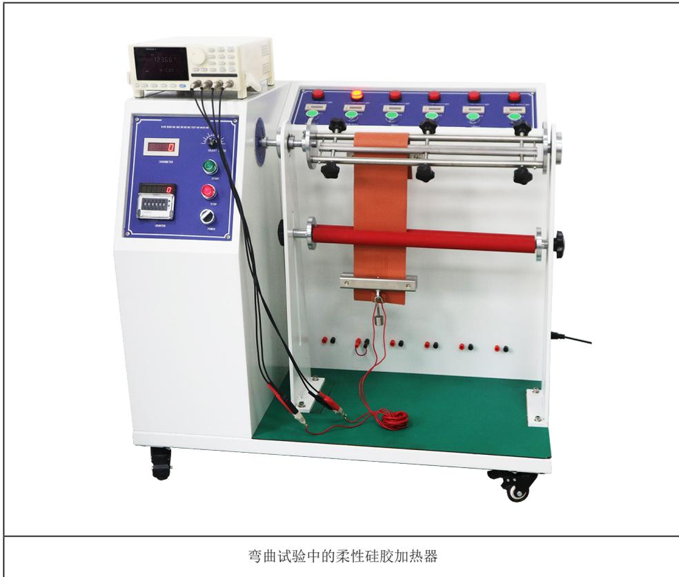
弯曲试验中的柔性硅胶加热器
