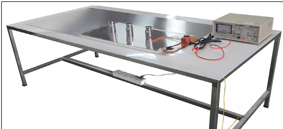
Dispositif de mesure de la résistance d'isolement.
