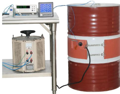
Variation de la température dans le temps de la température d'un fût métallique de 220 litres, rempli d'eau, réchauffé par une ceinture chauffante silicone de largeur 200mm, sans isolation thermique, de puissance 2250W (charge surfacique  $0.75\text{W}/\text{cm}^2$ ).
