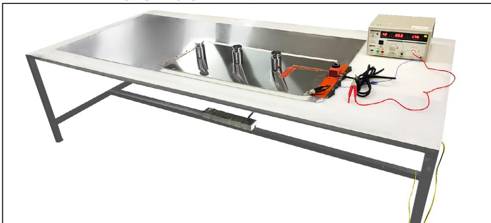
Equipement de mesure du courant de fuite total à froid
