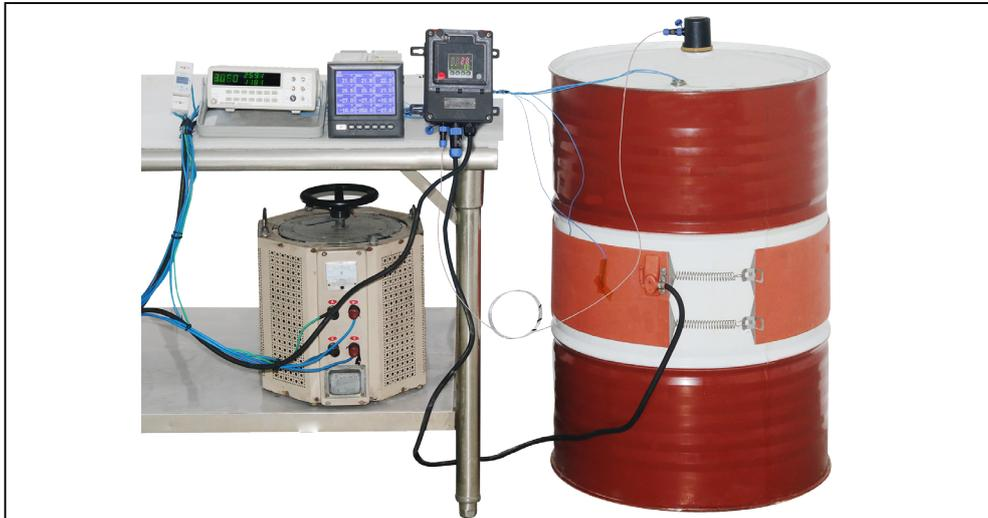
Variation de la température dans le temps de la température d'un fût métallique de 220 litres, rempli d'eau, réchauffé par une ceinture chauffante silicone de largeur 200mm, sans isolation thermique, de puissance 2250W (charge surfacique 0.75W/cm<sup>2</sup>).
