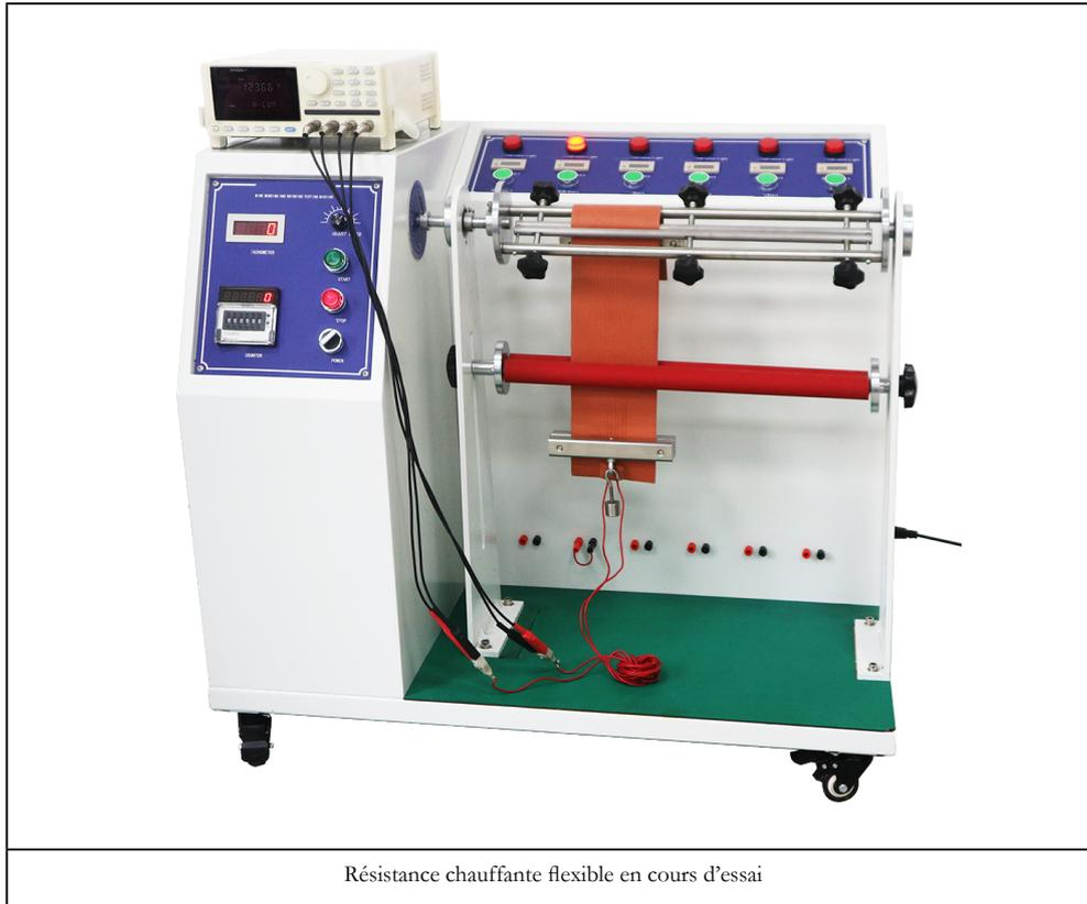
Résistance chauffante flexible en cours d'essai
