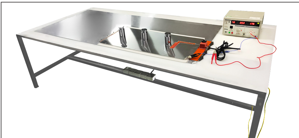
เครื่องมือวัดสำหรับการรั่วไหลของกระแสรวมที่สภาวะเย็น
