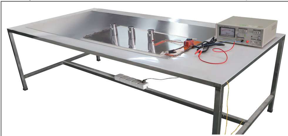
อุปกรณ์สำหรับวัดความต้านทานของฉนวน ค่าที่วัดได้จะมากกว่า 0.1 กิกะโอห์ม เสมอ
