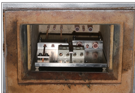
作为温度函数用于陶瓷电阻率的测试烤箱 (Ultimate 实验室)
