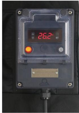
用于 NTC 传感器的电子温控器。带有预期的打开-关闭动作，数字显示。通过在布袋或毛毯加热器上的电缆进行远程控制连接。根据容器壁的温度来进行温度控制。
