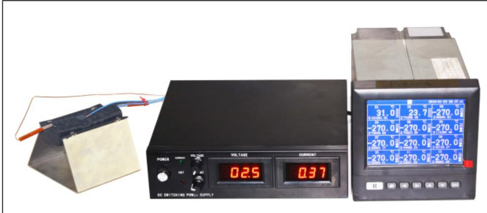
用于测量表面温度的设备，其作为毛毯加热器或布袋加热器表面 W/cm<sup>2</sup> 的函数
