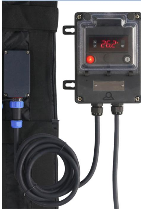
用于 NTC 传感器的电子温控器。打开-关闭动作，数字显示。远程墙壁安装。带有长的温度传感探头，用于浸入在液体中。可以在表面温度控制之外使用，以在达到液体的核心温度时结束再加热的过程。**注意：它不能直接用于加热的控制，除非它已经存在有一个表面温度的调节，因其不能代替它。**也可与 Pt100 温度传感器配合使用。
