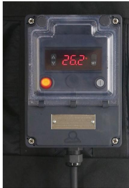
Thermostat électronique à thermistance, action tout ou rien avec boucle anticipatrice, affichage digital. Commande à distance par câble sur le connecteur de la couverture ou du manteau chauffant. Régulation en fonction de la température de paroi du réservoir.
