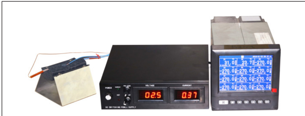
อุปกรณ์สำหรับวัดอุณหภูมิพื้นผิวเป็นฟังก์ชัน ของพื้นผิว วัดต/ซม. 2 ของเครื่องทำความร้อนแบบผ้าไหมหรือเครื่องทำความร้อนแบบแจ็คเก็ต
